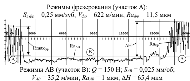
Рис. 2. Остаточная деформация поверхности детали из чугуна после торцевого фрезерования композитом 10 (участок А) и выглаживания (участок В)
