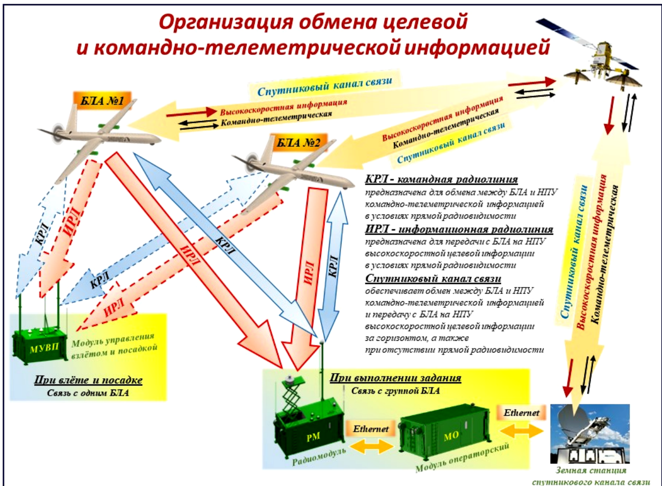
Рис. 1. Схема организации обмена целевой и командно-телеметрической информацией между двумя БЛА (вариант) и НПУОИ
