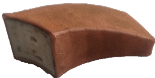
Рис. 4. Металлизация токонепроводящего основания
