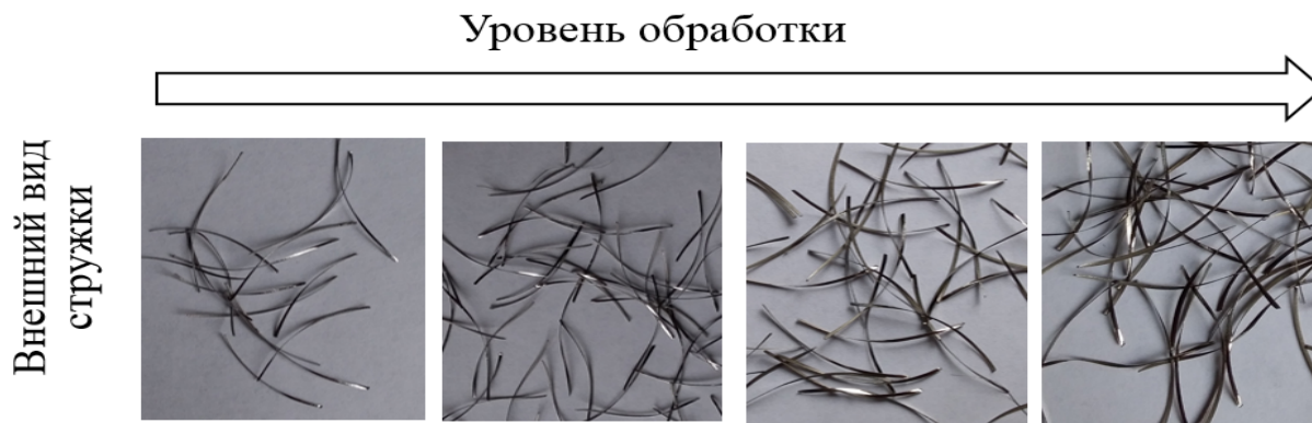
Рис. 2. Внешний вид стружки в зависимости от уровня обработки
