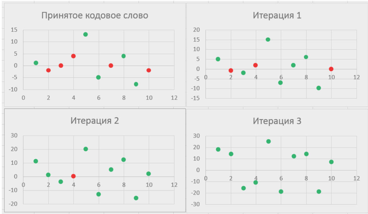
Рис. 12. Процесс итеративного декодирования небольшого отрезка кодового слова при малом отношении сигнал/шум
