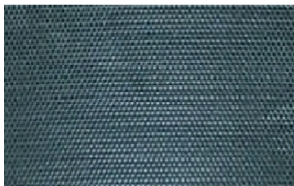
Рис. 3. Сектор фильтрующего элемента изготовленного электроэрозионным способом
